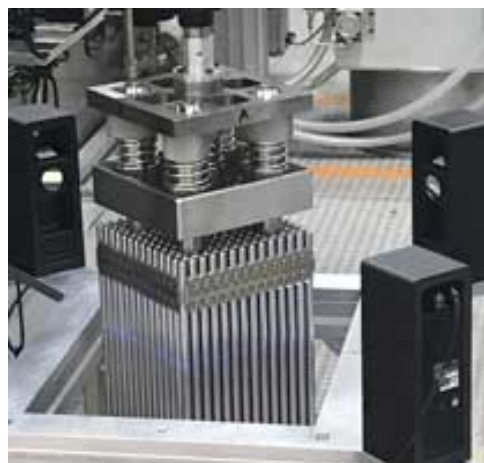
Assemblage de combustible EATF de Framatome
