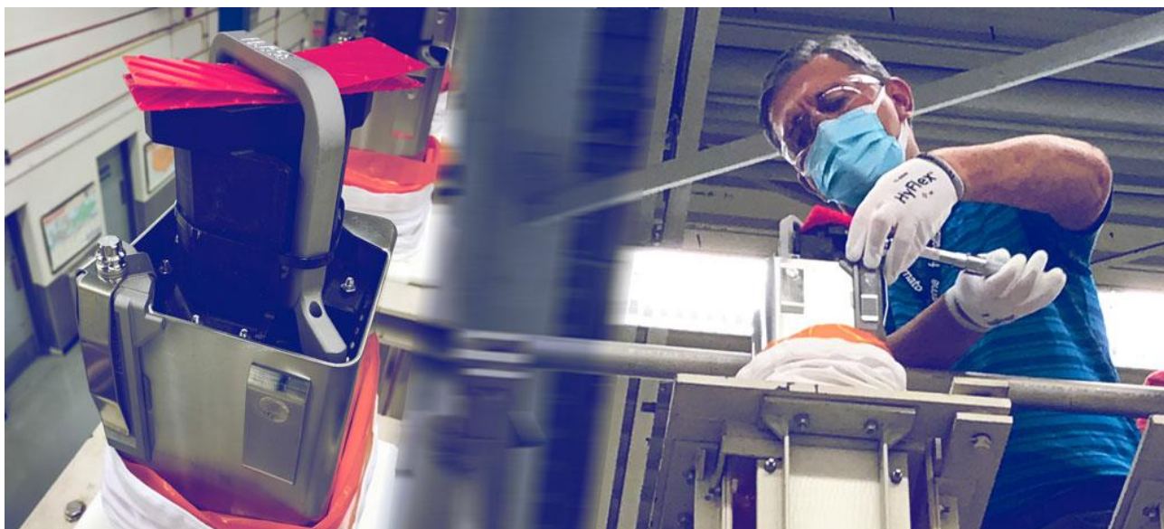
Composant avec une fonction sûreté imprimé en 3D pour chargement dans un réacteur américain
