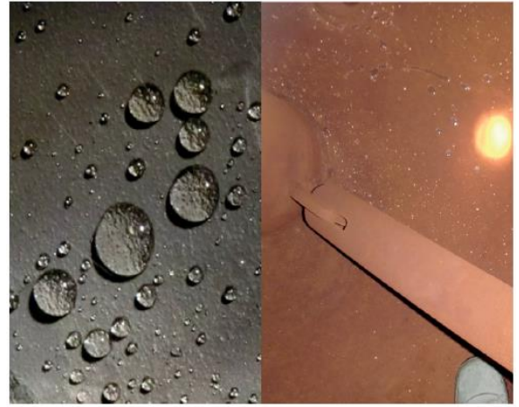
目视检查和水滴测试：冷凝器地板和受保护的氧化层
