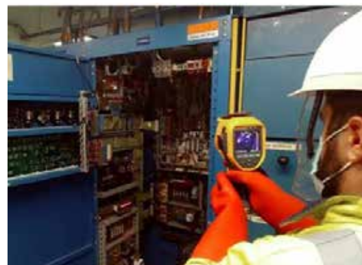
Thermographie en cours de réalisation sur un onduleur
