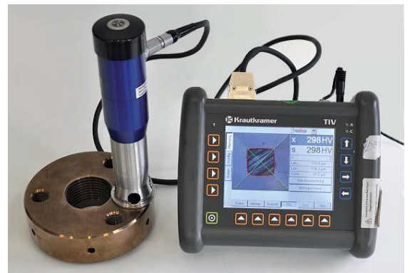
Mobiler TIV-Härteprüfer zur Bestimmung der Vickershärte von Werkstoffen
