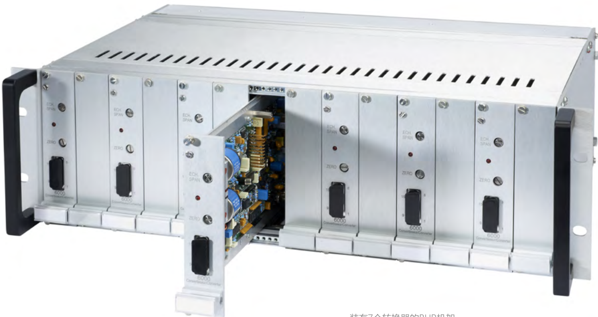
装有7个转换器的BUR机架
