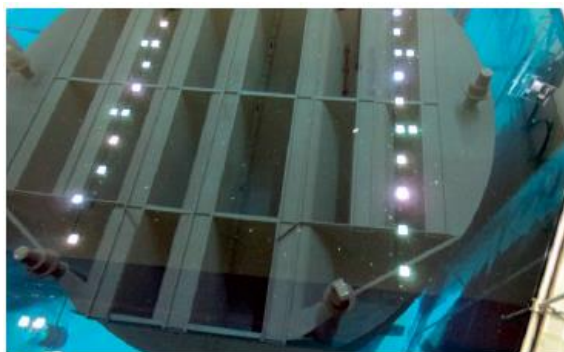
去污前的蒸汽干燥器：必须水下储存
