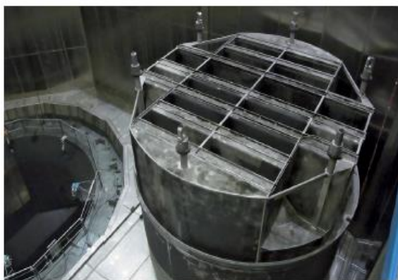
去污后的蒸汽干燥器：干式储存，无气载放射性
