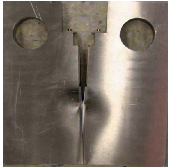
Bruchmechanikprobe nach der Prüfung
