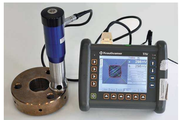
TIV-Härteprüfer zur Bestimmung der Vickershärte von Werkstoffen
