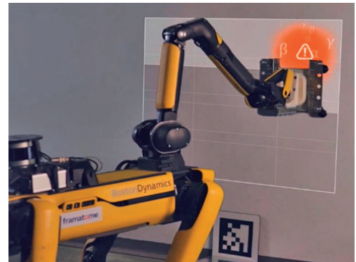
Mesures de radiation d'une zone quadrillée et marquage des points chauds
